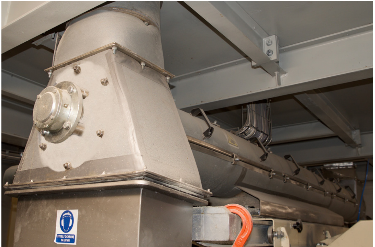
Wybierak ślimakowy stabilizujący 20 t/h
