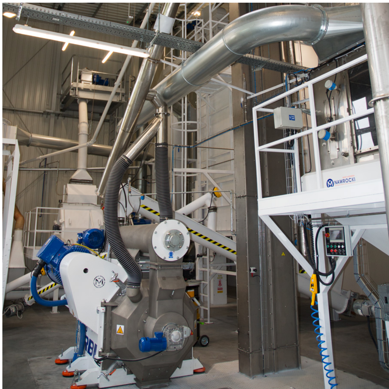
Fabryka pelletów z biomasy leśnej, do 2 t/h
